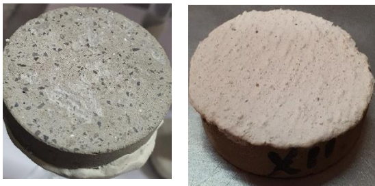
Figura 1.- Probetas de concreto A) s/nanoflex B) c/nanoflex
